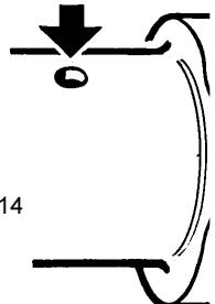
Instalar el transmisor en el tubo de escape, cerca de la brida del colector de escape.
